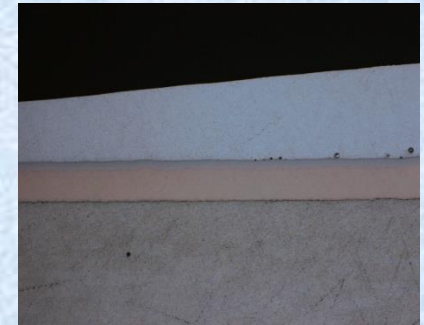
3- 2.5 mils Cu +Ni, No separation
