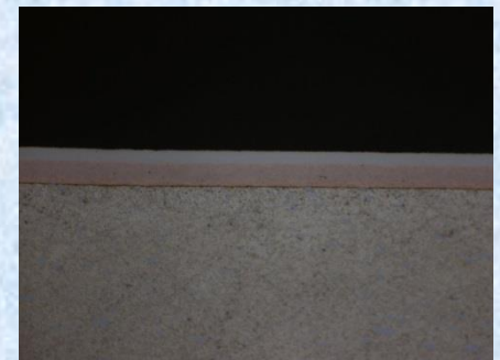
3- 0.5 mils Cu +Ni, No separation
