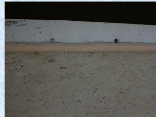
4- 1.0 mils Cu +Ni, No separation
